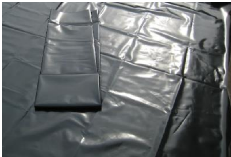
Slika 33: Folija za ribnik (vodoodporna membrana) Vir: Suzana Loparič, 2021
