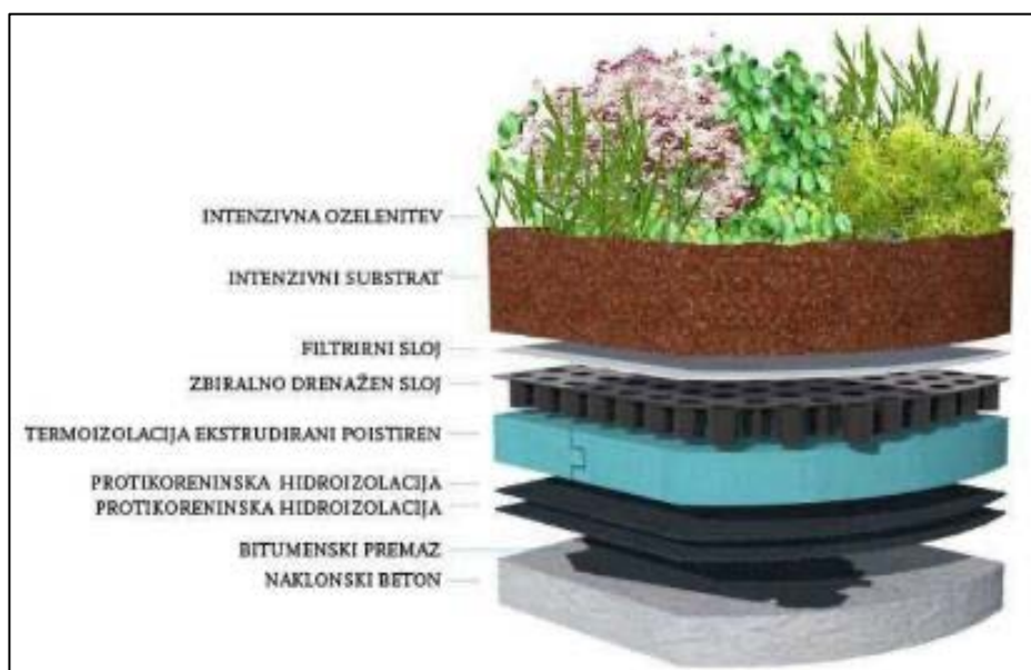
Slika 12: Prerez intenzivno ozelenjene strehe
