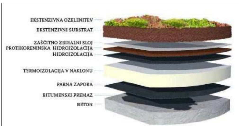
Slika 11: Prerez ekstenzivno ozelenjene strehe
