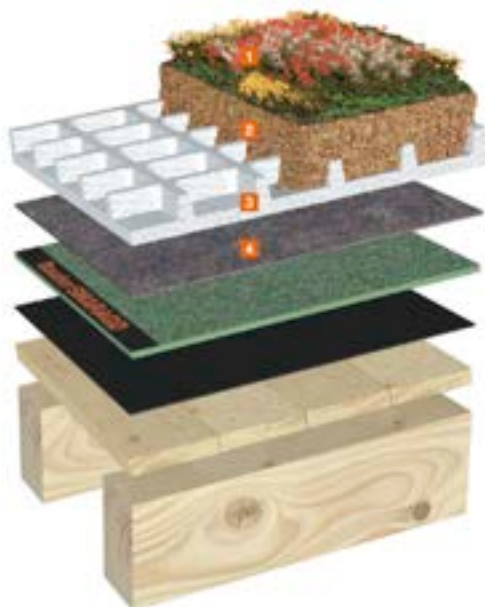
Slika 74: Sestava ozelenjene poševne strehe z nagibom od 5 do 15 stopinj.
