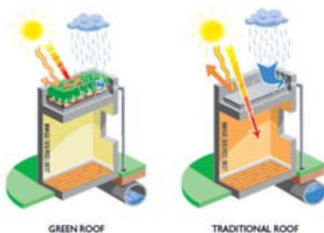
Slika 66: Razlike med zeleno streho in klasično ravno streho
