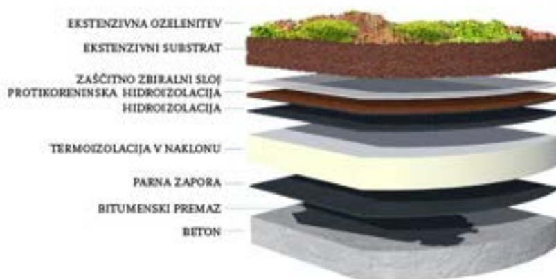
Slika 71: Vrstni red izolacijskih slojev na topli strehi
