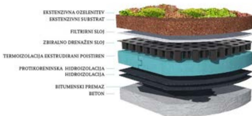
Slika 70: Vrstni red izolacijskih slojev na obrnjeni strehi
