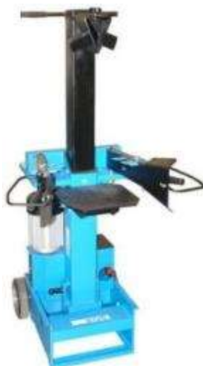
Slika 7: Manjši hidravlični cepilnik – elektromotorni pogon Vir: https://www.trisa.si/trgovina/cepilniki/cepilnik_dhh_10508_tc/
