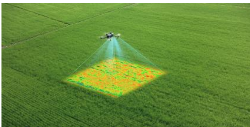
Slika 3: Dron z multispektralno kamero za zaznavanje poškodb na posevkih.
