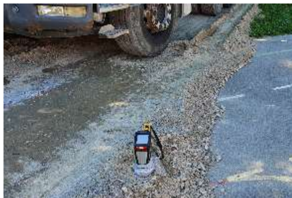
Slika 2: Meritve kovin s prenosnim rentgenskim fluorescenčnim analizatorjem (pXRF) na terenu
