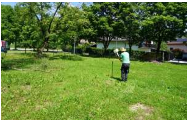
Slika 1: Vzorčenje tal s sondo za ugotavljanje prostorske (horizontalne in vertikalne) razsežnosti onesnaženosti
